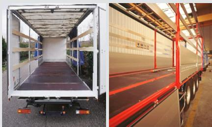
изготовление полов в фургонах грузовых автомобилей (фанера с сетчатой поверхностью)
